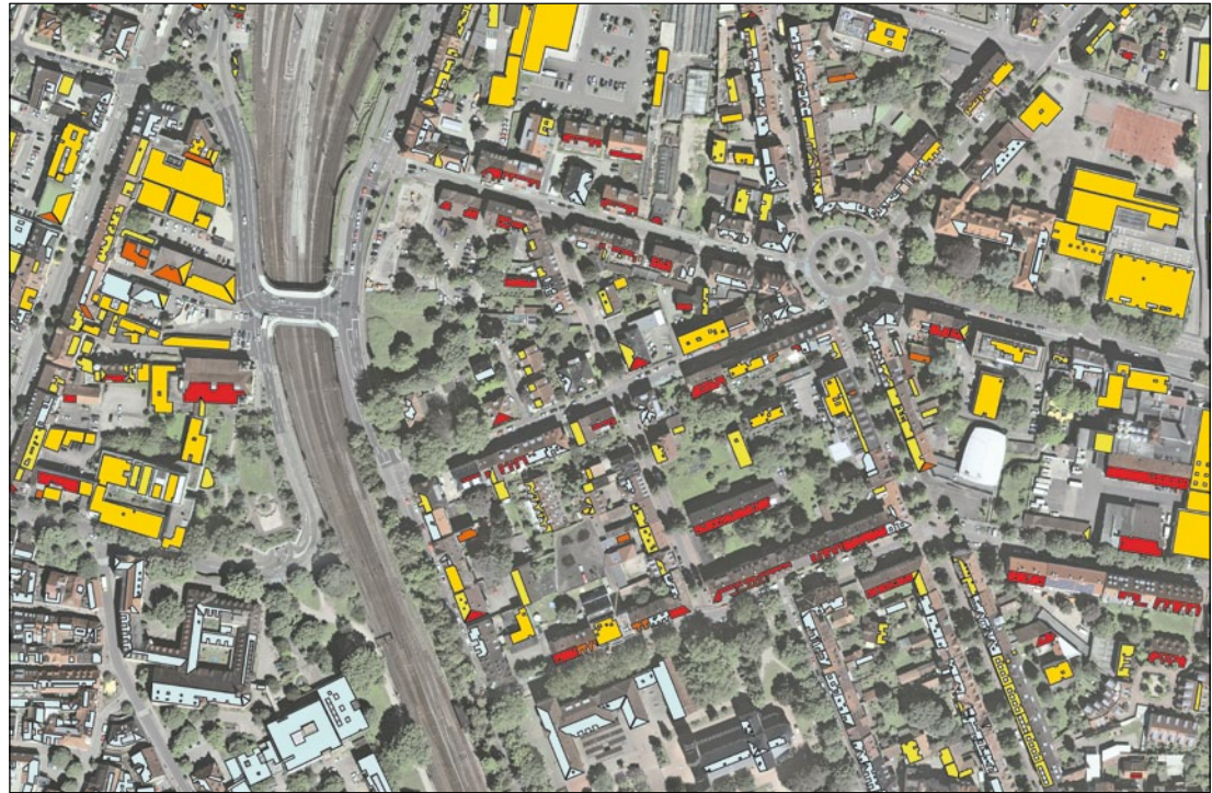
Solarkataster: Die Eignung der Hausdächer für solare Nutzung lässt sich über die Farbgebung im Solarkataster einfach ermitteln. Foto: Stadt Offenburg/Bauservice
