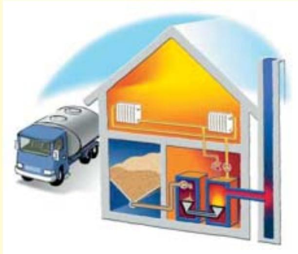
**HACKSCHNITZEL-Heizungen** haben das gleiche Funktionsprinzip wie Pelletheizungen. Aufgrund des großen Lagerraumbedarfs, einer größeren Rangierfläche für die Anlieferung der Hackschnitzel und der höheren Investitionskosten ist dieses System eher für größere Wohneinheiten bzw. Heizwerke geeignet. Niedrige Brennstoffkosten machen die Nutzung attraktiv.
