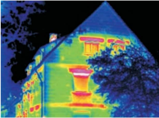
Thermografie: Wärmebrücken am Gebäude
